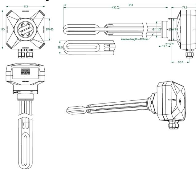
inactive length = Distanz ab Gewindekopf, die nicht beheizt wird (120 mm)
