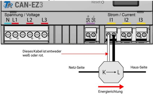
Jeder Stromwandler muss sorgfältig geschlossen werden, indem der Schnappverschluss spürbar einschnappt.
